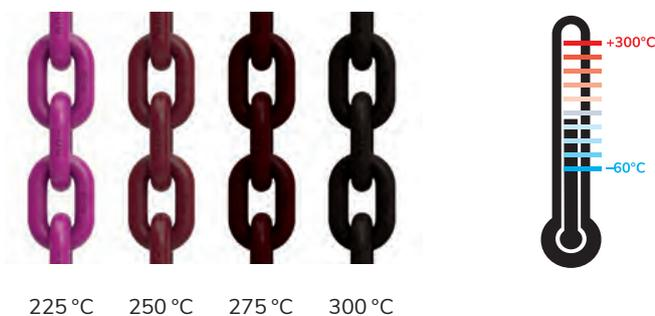
Auch die fluoreszierende Pink-Pulverbeschichtung der VIP-Kette verändert bei extremen Einsatztemperaturen dauerhaft ihre Farbe – in diesem Fall bei über 200 °C. Bei einer unzulässigen Erhitzung über 380 °C ändert sich der Farbton zu Tiefschwarz, und es bilden sich kleine Blasen. Die VIP-Kette muss dann ausgetauscht werden.
