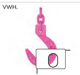
Bei 1D-, 1E-, 1F-Container (< 9 ft) kann mit 4-Strang, max. Neigungswinkel 30° an oberer Containerecke angehoben werden.
