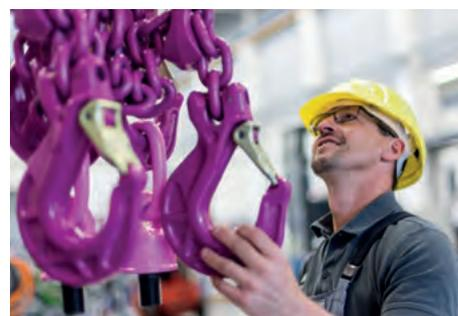
**Achtung:** Wenn Sie Gehänge selbst zusammenstellen, dürfen Sie dazu ausschließlich Anschlagketten verwenden! Zurrketten sind für den Hebeeinsatz nicht zulässig, da sie über einen anderen Sicherheitsfaktor verfügen als Anschlagketten.
