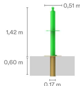
Hülse zur fixen Montage in Beton
