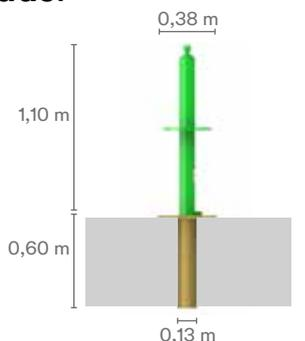
Hülse zur fixen Montage in Beton **8530872**
