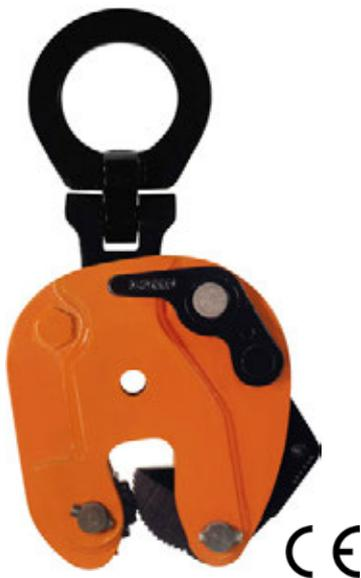
Das **Modell JPA** ist eine Vertikal-Tragklemme für das 180°-Wenden einer einzelnen Platte oder eines einzelnen Teils aus der Horizontalen in die Vertikale. Mit einer zusätzlichen Druckastensverriegelung. Erlaubt die seitliche Belastung der Aufhängeöse bis 90 Grad durch Reduzierung der Nennkapazität der Tragklemme. Tragfähigkeitsreduzierungen entnehmen Sie bitte der Abb. 1.
