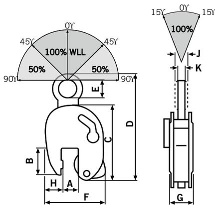
Die IP10-Klemmen eignen sich zum Anheben, Wenden um 180° und vertikalen Transport von Stahlblechen und Konstruktionselementen. Die IP10-Klemmen sind standardmäßig mit RFID-Tag ausgestattet.
