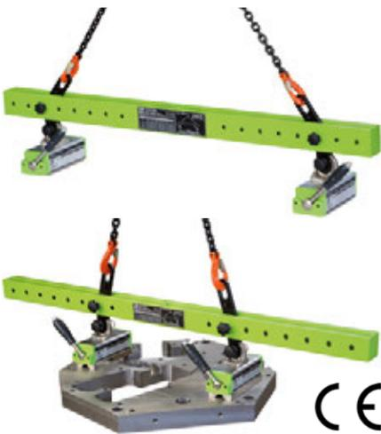
FX-LT Magnettraversen sind den Bedürfnissen von Blechverarbeitern, Laser- und Brennschneidern angepasst. Zwei FX-V Lasthebemagnete und eine leichte Distanztraverse mit Zweistrangkettengehänge ermöglichen das Be- und Entladen von Maschinen mit Blechen, oder das waagerechte Aufnehmen von Werkstücken mit mittigem Ausschnitt. Mit
