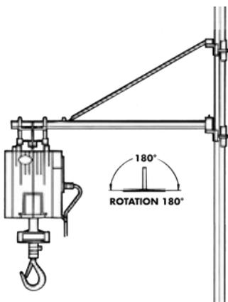
Für den Betrieb des Bauseilzuges empfiehlt sich der um 180° schwenkbare Tragarm, der mit 2 Schellen an einem senkrechten Rohr geklammert wird und eine Traglast von bis zu 600 kg hat.
