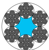
Kabelschlagseile haben bei gleichem Durchmesser eine geringere Tragfähigkeit, sind aber deutlich flexibler und anschmiegsamer, was im Einsatz von Vorteil sein kann. Als Endverbindungen sind nur folgende Arten zulässig:
