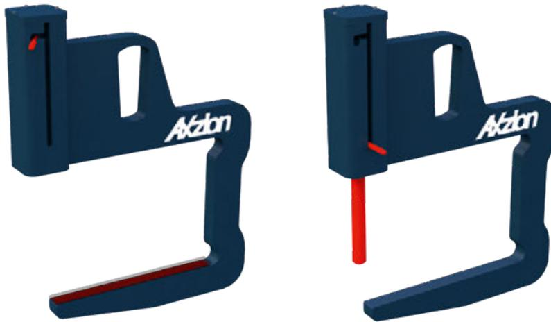
Beim Transport von Spaltbändern ist eine zusätzliche Sicherung erforderlich. Beim Einfahren in die Last wird der Schiebolzen in der oberen Position arretiert, beim Transport der Spaltbänder verhindert der Bolzen das Herauskippen der schmalen Coils.
