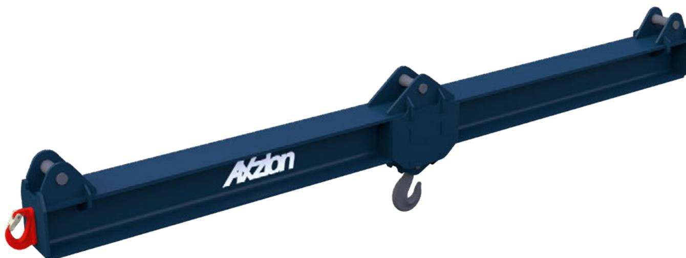
Mit der 2-Kran-Traverse können zwei Krane gekoppelt werden, so dass sich die Tragfähigkeiten addieren. Lastseitig wird eine Kranhakenaufhängung DIN 15411 mit Einfach-Kranhaken DIN 15401 oder Doppel-Kranhaken DIN 15402 eingesetzt.
