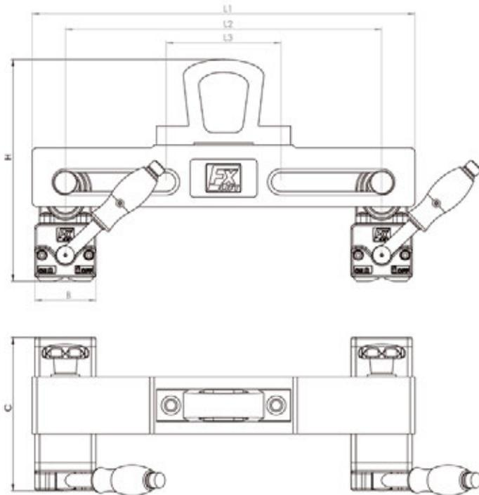
FX-KT Kleintraversen sind den Bedürfnissen von Blechverarbeitern, Laser- und Brennschneidern angepasst. Die im Lieferumfang enthaltenen FX Lasthebemagnete ermöglichen, in Kombination mit der justierbaren Kleintraverse, den Transport von Werkstücken mit zentrischem Ausschnitt.
