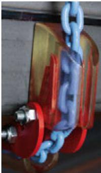
Die Anschlagkette allein darf als Anschlagmittel ohne Kantenschutz nur eingesetzt werden, wenn eine 20%ige Reduzierung der Tragfähigkeit berücksichtigt oder die nächstgrößere Kettendicke verwendet wird. Ansonsten muss ein secutex-Gelenkkantenschoner SK-K verwendet werden.
