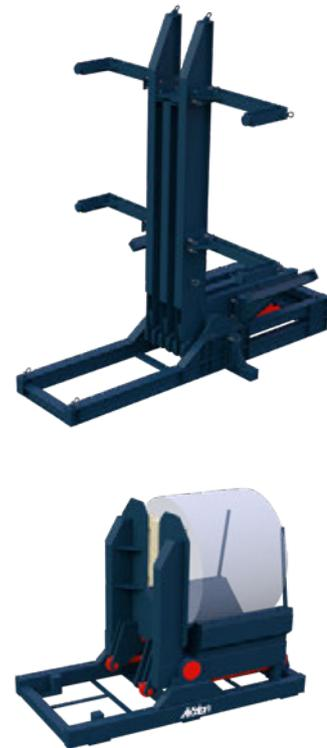
Coil-Wendetische sind die sichere und schnelle Lösung zum Wenden von Coils und Spaltbänder. Das Coil wird mit dem Kran oder dem Gabelstapler aufgelegt und auf Knopfdruck gewendet. Der bewährte Standardantrieb erfolgt elektromechanisch über einen robusten Getriebemotor.
