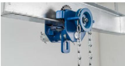
Durch Ziehen an der endlosen Handkette (2,5m Handkettenbedienlänge) nach rechts oder links wird das Transportgut mit diesem Haspelketten-Fahrwerk bewegt.
