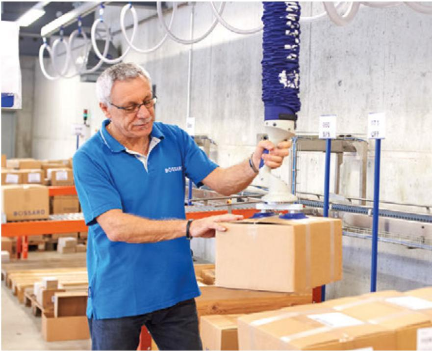
Mit dem Vakuum-Schlauchheber JumboFlex bewegen Sie leichtere Güter bis 50 kg ergonomisch und in hoher Taktzahl. Sein Bediengriff liegt gut in der Hand und ermöglicht langes ermüdungsfreies Arbeiten. Über die zentrale Ein-Finger-Steuerung heben, senken und lösen Sie die Last intuitiv.
