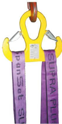
Anschlagmittel, z. B. Rundschlingen oder Hebebänder, dürfen im Haken nicht aufeinanderliegen, da die unteren Anschlagmittel sonst gequetscht werden und somit die Gefahr der Beschädigung besteht. Durch den Einsatz des Doppelhakens können die Anschlagmittel auf die beiden Haken verteilt werden, so dass eine Beschädigung oder Tragfähigkeitsreduzierung vermieden wird. Hakenform in Abhängigkeit vom Anwendungsfall.
