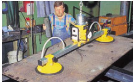
**i** Für die größtmöglichen Lastabmessungen ist entscheidend, dass beim Heben keine Lastbiegung eintritt.
