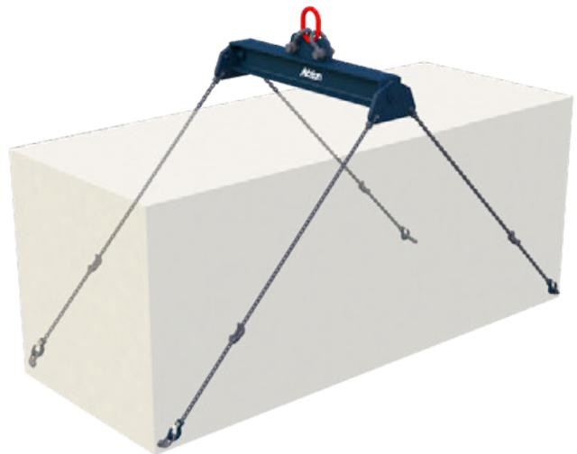
Robuste Traverse geeignet für das Heben von 20" oder 40" ISO-Containern. Kranseitig mit Vario-Aufhängung, lastseitig ausgerüstet mit 2x 2 Güteklasse 10 Ketten mit Containerhaken.
