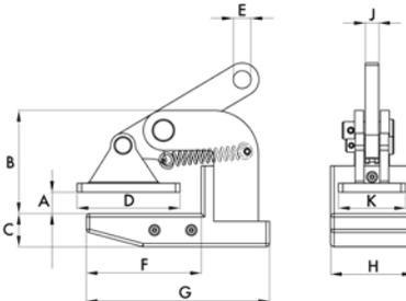
Die IPHNM10-Schongreifer eignen sich besonders für den Transport von Blech- und Stahlkonstruktionen in horizontaler Stellung.
