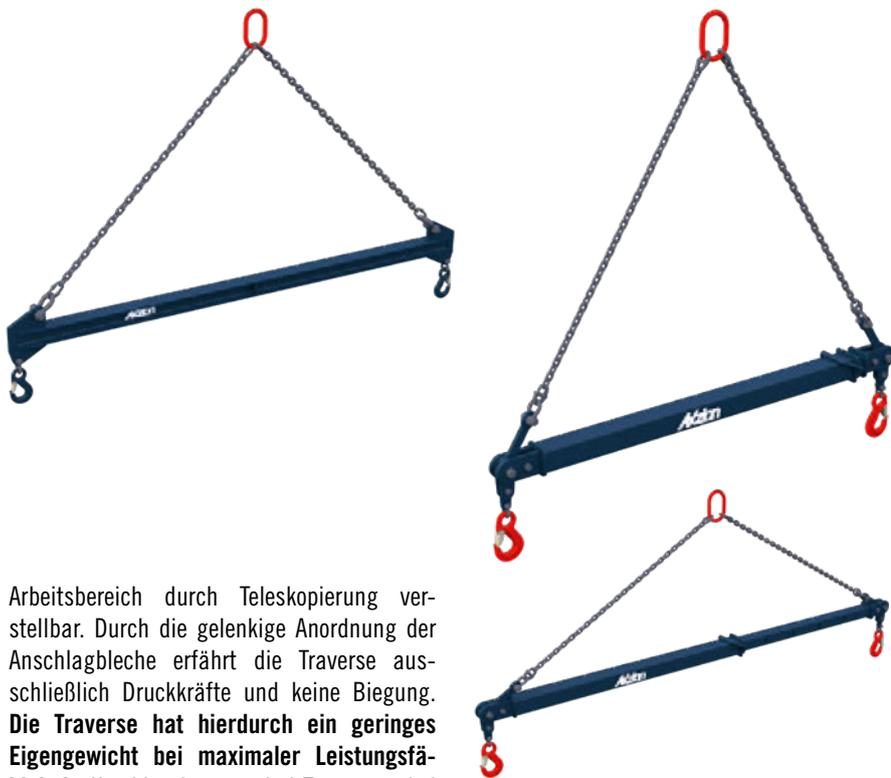
Arbeitsbereich durch Teleskopierung verstellbar. Durch die gelenkige Anordnung der Anschlagbleche erfährt die Traverse ausschließlich Druckkräfte und keine Biegung. **Die Traverse hat hierdurch ein geringes Eigengewicht bei maximaler Leistungsfähigkeit.** Kombination von drei Traversen, bei der zwei Untertraversen an einer Obertraverse angehängt werden, sind möglich.
