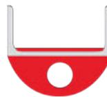
Selbst leichte Druckstellen können die Statik eines Hochregallagers negativ beeinflussen. Der Anfahrerschutz für Regalstützen schützt vor Beschädigungen durch den frontalen Aufprall. Die Hohlkammern im Prallschutzprofil dämpfen die Aufprallenergie, das solide Stahlprofil verhindert ein Einknicken. Die halbrunde Ausführung erleichtert so das Einfahren zwischen den Regalstützen.
