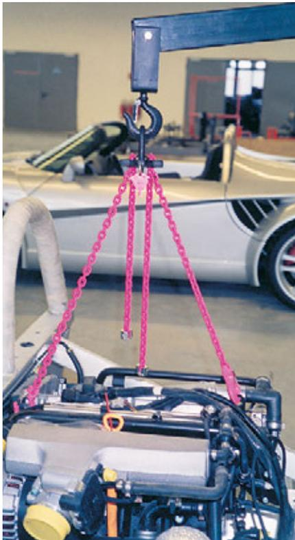
Der Mini-Baukasten ist die ideale Ergänzung für jedes Hebezeug. Durch die Kombination der besonders leichten Anschlagkette mit 4 mm Durchmesser mit anwendungsoptimalen Bauteilen lassen sich Kleinlasten bis 1320 kg einfach und flexibel heben.
