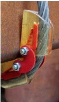
Der Kantenschoner SK-D kann sich durch sein Gelenk optimal an die jeweilige Lastgeometrie anpassen. Über den Montageschlitz kann der Kantenschoner schnell auf das Drahtseil aufgeschoben und an die Kante angesetzt werden. Das Drahtseil gleitet durch den secutex-Clip und verbleibt auch beim Abschlagen am Hebeband.
