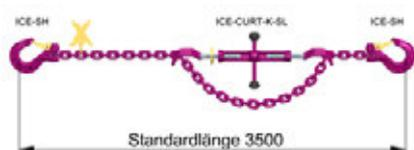
ICE-Zurrkette-Standardausführung mit unverlierbar auf dem Kettenstrang montierten, jedoch verschiebbaren ICE-Knebelspanner ICE-CURT-K-SL mit Schnellverkürzungsanschluss. Blitzschnelles Vorspannen und Verkürzen ohne Totweg. Erhebliche Gewichtsersparnis gegenüber Zurrketten der Güteklasse 8 bei verbesserter Handhabung. Länge: 3500 mm. Beachten Sie die DIN EN 12195-3, VDI 2700.
