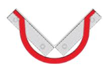
Dieser Anfahrerschutz wird am Boden verschraubt. Der Prallschutzlappen absorbiert die Aufprallenergie des Gabelstaplers oder des Hubwagens.
