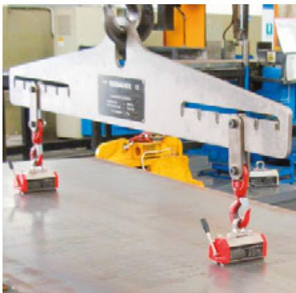
Das spezielle Design der Polschuhoberflächen ermöglicht eine optimale Konzentration und Verteilung der Magnetkraft. Der MaxX TG ist besonders für dünnwandige Materialien (Bleche) geeignet. Die bekannten Sicherheits- und Zuverlässigkeitsmerkmale der MaxX Lasthebemagnete bleiben dabei erhalten.
