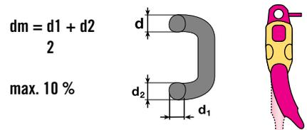
**i** 1 x jährliche Überprüfung der Anschlagkette und Dokumentation der Prüfung sowie 3-jährige, zerstörungsfreie Prüfung gesetzlich vorgeschrieben nach DGUV Regel 100-500 / BGR 500 sowie Maschinenrichtlinie 2006/42/EG. Wir bieten Ihnen eine vertragliche Regelung des Prüfservices und der Instandhaltung Ihres Anschlagmittels.
