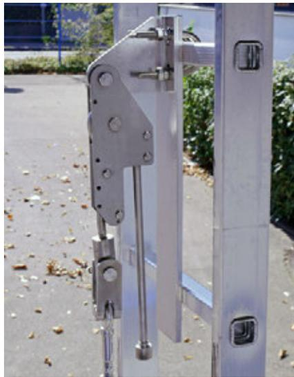
Systemfalldämpfer am oberen Befestigungspunkt
