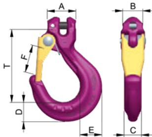
Robuste, nochmals verbesserte Ausführung. Sicherungsfall in Hakenspitze einrastend, dadurch gegen seitliches Verbiegen geschützt. 3-fach gewickelte, nichtrostende Doppelschenkelfeder. Komplett mit Verbindungsbolzen und Spannhülse vormontiert. ICE-Mini-Haken sind mit dem RUD ID-POINT® (RFID-Chip) ausgestattet und können über die eindeutige Identifikationsnummer zugeordnet werden.
