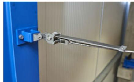
Immer wieder besteht der Bedarf, ein festes System auch über dem Kopf des Anwenders montieren zu müssen. Diese Systeme sind oft sehr lang. Zwischenhalterungen innerhalb der Seilsysteme sind in den meisten Fällen sehr störend, da der Seilläufer diese Zwischenhalterungen nicht sauber überfahren kann. Zusätzlich werden diese Systeme oft mit Höhensicherungsgeräten betrieben, und damit diese präzise und reibungsarm über das Seil laufen, benötigt man hierfür eine hohe Vorspannung im Seilsystem.
