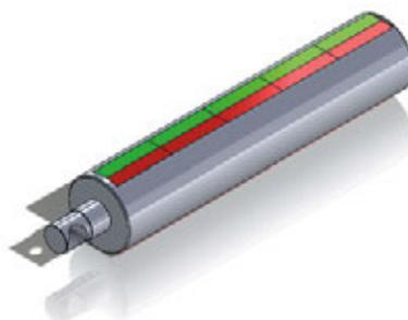
Herkömmliche Lasthebemagnete: Ausgefräbte oder geschweißte Schaltwelle mit eingebauten Magneten, 180° theoretischer Schaltweg, geschwächte oder geschweißte Welle, 3 Luftspalte!
