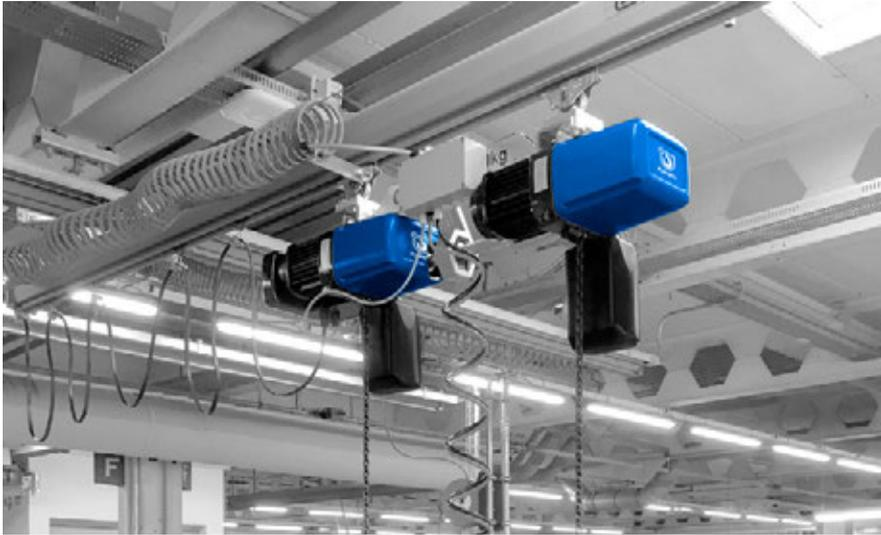
Der PEH ist einfach im Aufbau und enthält keine sensible Elektronik, was das Risiko von Betriebsausfällen minimiert. Er zeichnet sich durch hohe Laufruhe aus und ist auf Langlebigkeit im harten Einsatz ausgelegt.
