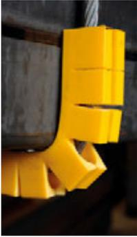
Auch bei der Ladungssicherung muss das Drahtseil gegen die „Scharfe Kante“ geschützt werden. Der secutex-Einfachkantenschoner SK-DE wird einfach über den rückseitigen Montageschlitz über das Drahtseil geschoben und ist dadurch unverlierbar befestigt. Durch das geringe Eigengewicht und die flexible Gewebeverstärkung kann der Kantenschoner leicht und schnell an die Last angelegt werden.
