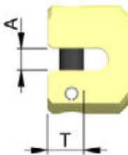
Zur Sicherung des Kettenstranges bei Anwendung des ICE-Mini-Lifters als Einstrang-Verkürzung. Wir empfehlen den ICE-Mini-Lifter grundsätzlich mit 2 Stück ICE-Mini-Haken auszurüsten, dann ist ein universeller Einsatz möglich und die Kette kann nicht versehentlich durch den Mini-Lifter gezogen werden.
