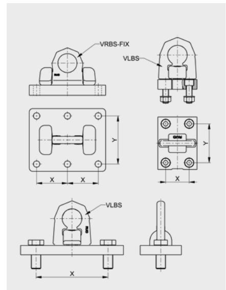
**Beispiele für Sonderkonstruktionen von schweißbaren Anschlagpunkten auf Anschraubplatten**
