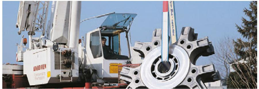
für die Anbringung des Anschlagmittels sind keine Seltenheit. Hier bietet SpanSet Ihnen das CS-Hebebänder, das aus PES-Garnen gewebt und in vier Lagen vernäht ist. Der Effekt: Ein Hebebänder, das bei geringerer Gurtbreite deutlich mehr Tragfähigkeit besitzt als ein- oder zweilagige Hebebänder. Dadurch sind die PowerStar CS-Hebebänder ideal für Anwendungen, bei denen es auf einen schmaleren Gurt ankommt – etwa zum Durchstecken unter der Last.
