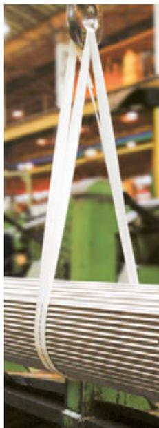
Hebebandschlingen für den einmaligen Einsatz werden benötigt, wenn z.B. ein schweres oder sperriges Produkt über längere Distanzen ausgeliefert wird. Ist die Ladung beim Endverbraucher angekommen, werden die Anschlagmittel nach der Verwendung entsorgt. Ihr Vorteil: Sie sparen Kosten, denn die Hebebandschlingen für den Einweg-Einsatz sind wesentlich preisgünstiger als solche für den täglichen Einsatz.
