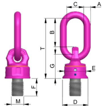
**i** Achtung: VWBG sind nicht für Dauerdrehbewegungen unter Last geeignet! Nicht unter 90° mit Volllast drehbar!
