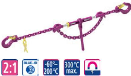
ICE-Zurrkette-Standardausführung mit unverlierbar auf dem Kettenstrang montierten, jedoch verschiebbaren ICE-Ratschenspanner ICE-CURT-SL mit Schnellverkürzungsanschluss. Blitzschnelles Vorspannen und Verkürzen ohne Totweg. Erhebliche Gewichtsersparnis gegenüber Zurrketten der Güteklasse 8 bei verbesserter Handhabung. Länge: 3500 mm. Beachten Sie die DIN EN 12195-3, VDI 2700.
