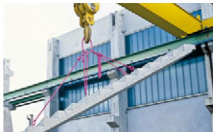
Sonderaufhängeköpfe mit der inneren Breite 140 mm, 190 mm und 250 mm für größere Kranhaken.
