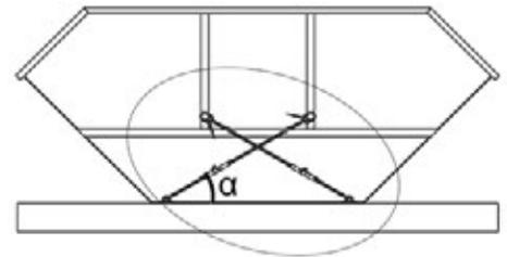
Die abgebildeten Ausführungen zeigen beispielhaft den Aufbau der RUD-Behälter-Zurrketten.
