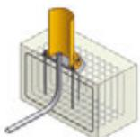
Die klassische Fundamentbefestigung (Tiefe 1000 mm) für den Säulenmanipulierkran BOY. Im Lieferumfang enthalten sind Ankerschrauben, Muttern, Schrauben, Schablonen und eine Fundamentherstellanleitung.
