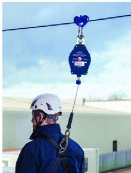
Die SpanSet-Hörsicherungsgeräte sichern z. B. in Kombination mit einer Anschlageinrichtung bei Wartungs- und Montagearbeiten. Die integrierte Falldämpfung bremst und hält die zu sichernde Person beim Fall sicher fest. Die Hörsicherungsgeräte ohne Rettungshub sind am Gehäuse mit einem Twistlockkarabiner ausgestattet und somit direkt einsatzfähig.
