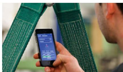
Eine scharfe Kante liegt immer dann vor, wenn der Kantenradius „r“ kleiner als die Materialstärke „d“ des Anschlagmittels ist. Ist die Last scharfkantig oder hat die Last eine raue Oberfläche, muss das textile Anschlagmittel mit geeigneten Abriebschutz-, Schutzschläuchen oder Festbeschichtungen ausgerüstet werden.
