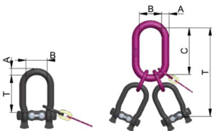
Aufhängekopf mit integrierter Verkürzungsmöglichkeit, speziell für 4 mm-ICE-Anschlagkette. Durch Drücken der Arretierbolzen wird das Kettenkreuz entriegelt, Kette kann dann eingefädelt bzw. in der Länge verstellt werden. Ideal für Kleinlasten bis 1120 kg (bei 2-Strang-Anwendung) bzw. bis 1700 kg (bei 4-Strang-Anwendung).
