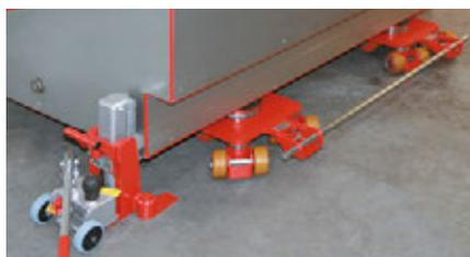
FM.JLF.035 in Verbindung mit hydraulischem Hebegerät
