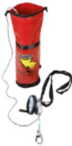
Das CRD-Abseilgerät hat ein integriertes Spezialgetriebe samt Handkurbel. Damit können Sie sogar bewusstlose Personen ohne fremde Hilfe anheben, z. B. aus dem Führerstand eines Krans. Beim Abseilen sorgt die Fliehkraftregelung des CRD („Constant Rate Descender“) automatisch für eine konstante, definierte Abstiegs geschwindigkeit. Einzelpersonen können Sie damit aus bis zu 400 m Höhe retten. Im Falle einer Evakuierung kann
