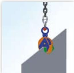
IPU10H und IP10H vertikale Hebeklemmen eignen sich zum Heben, Wenden (180°) und vertikalen Transportieren von Stahlblechen und -sektionen mit einer sehr großen Oberflächehärte bis max. 47 Rc (450 HB). Diese Hebeklemmen sind mit Zahnkreis und Zahnsegment aus außerordentlich hartem verschleißfesten Material ausgeführt.
