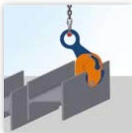
Die IPBKZ Trägerklemme wird für das Heben, Transportieren und Stapeln von H-Trägern eingesetzt. Ein Tragring, dessen Zentrum über dem Balkenschwerpunkt liegt, erlaubt es, die Balkenflanke vertikal zu halten. Diese Klemmenserie kann für vertikale und horizontale Bewegungen eingesetzt werden, für den Transport und das Stapeln verschiedener Typen von Baukonstruktionen wie z.Bsp. I-Trägern, Winkeln usw., abhängig von der gewünschten Anwendung.
