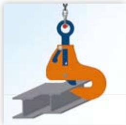
Die IPBSNZ Trägerklemme wird für das Heben, Transportieren und Stapeln eingesetzt. Der außermittig angesetzte Tragring erlaubt den geraden Hub von I-Trägern genauso wie den von Hubkonstruktionen und Schiffsektionen. Diese Klemmserien können für die vertikale und horizontale Bewegung eingesetzt werden, für das Transportieren und Stapeln verschiedener Stahlkonstruktionen wie z.Bsp. I-Trägern, abhängig von der gewünschten Anwendung.
