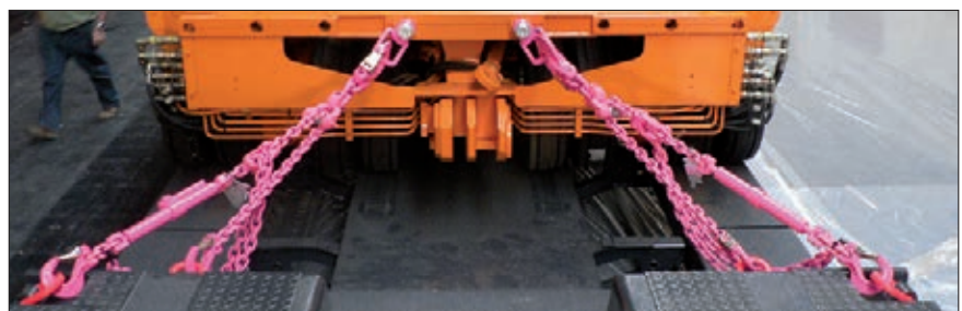
Vier tragende Stränge durch VIP-Zurrketten mit Spezialumlenkrollen
