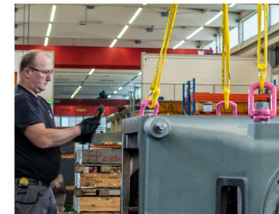
Unverzichtbare Ergänzung: der Joker-Haken. In Kombination mit einer oder mehreren Rundschlingen entsteht so in kürzester Zeit ein Rundschlingen-Gehänge. **Mehr auf [www.spanset.de](http://www.spanset.de)**
