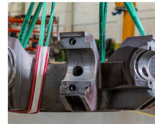
Schützen Anschlagmittel vor scharfen Kanten, erhöhen die Arbeitssicherheit und Standzeiten des Anschlagmittels: secutex-beschichtete Schutzschläuche sind leicht positionierbar, formstabil und extrem schnittfest. **Mehr auf [www.secutex.de](http://www.secutex.de)**
