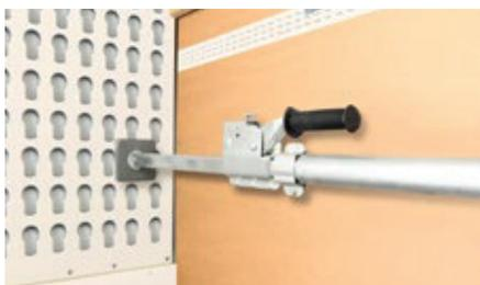
Der Klemmbalken **2** hilft nicht nur, die Ladung formschlüssig zu sichern, sondern dient ebenfalls zur horizontalen und vertikalen Laderaumtrennung. Der Klemmbalken ist stufenlos und von 2.180 mm - 2.844 mm verstellbar. Die rutschhemmenden, beweglichen Gummifüße an beiden Enden sorgen, neben dem sicheren Halt, für einen Schutz der Fahrzeugwand.
