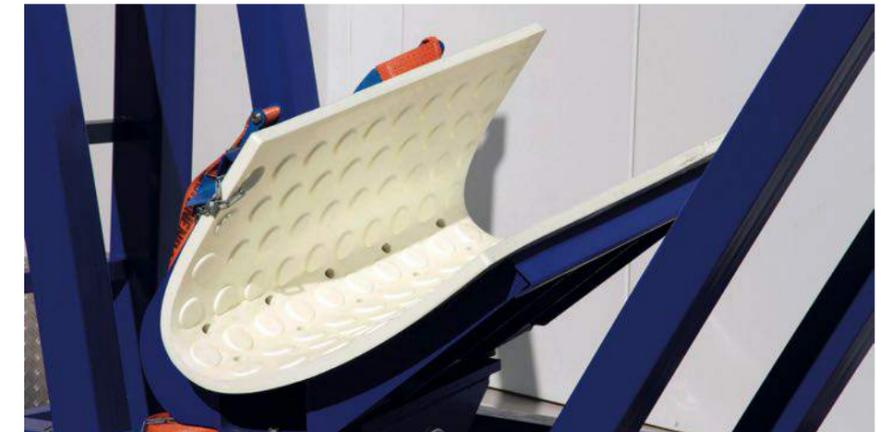
secuFoam, die klebbare Beschichtung, speziell entwickelt für die Transportgestelle für Rotorblätter
