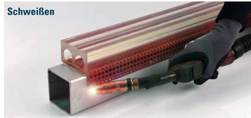
Oft ist das Schweißen die einfachste und sicherste Art der Befestigung. Die verschiedenen Lochblechausführungen ermöglichen einen sehr vielseitigen Einsatz.
