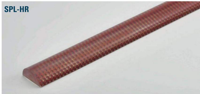
secutex-Prallschutz-Halbrund eignet sich zur Anwendung von runden Lasten, die im Unternehmen verarbeitet werden. Das innen liegende Lochblech verhindert eine Ausdehnung in Längs- und Querrichtung und lässt sich dadurch gut verschrauben.
