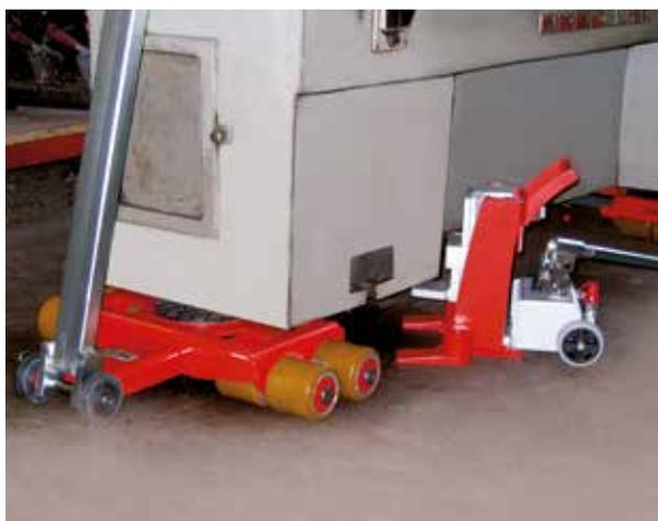
Kugelgelagerte Rollen garantieren einen leichten Lauf.
