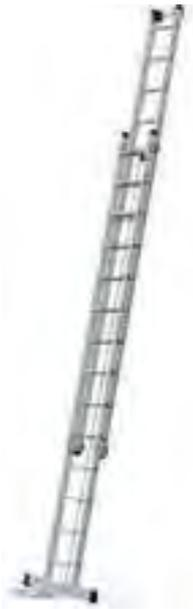
Die einfache und komfortable Höhenregulierung in der Vertikalen ist optimal für den Einsatz als Zugang zu großen Höhen. Besonders einfache und bequeme Höhenverstellung von Sprosse zu Sprosse im Raster von 280 mm durch Kunststoffseil und Rolle. Sichere Arretierung durch automatisch wirkende Einfallhaken. Oberleiter mit Laufrollen ausgestattet, Laufrollen mit abriebfester, wandschonender Lauffläche.
