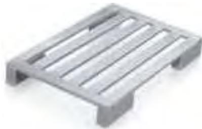
Hygienische Palette, robust und rollenbahngängig. Rahmen und Längssprossen aus geschlossenen, hochfesten und korrosionsbeständigen Aluminium-Profilen. Extra lange Eckfüße (L = 300 mm) vereinigen die Vorteile von Kufenunterbau und Eckfüßen. Sie sind z.B. rollenbahngängig und geeignet für Hochregallager. Großer Freiraum für Gabelzinken-Einfahrt. Keine störenden, durchgehenden Kufe, daher geringere Beschädigungsfahrer. Nahtstellen wasserdicht verschweißt.
