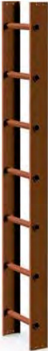
Sicherer Aufstieg auf verschiedenen Dachneigungen durch hochstabile, stationäre Leiter mit außermittiger Sprossenordnung. Trittsichere Vierkantsprossen mit 2 unterschiedlich geneigten Trittflächen. Stabile Holzprofile für 80 mm Sicherheitsabstand der Sprossen zur Dachoberfläche. Problemlose Abstimmung der Leiter auf die jeweilige Dachlänge.
