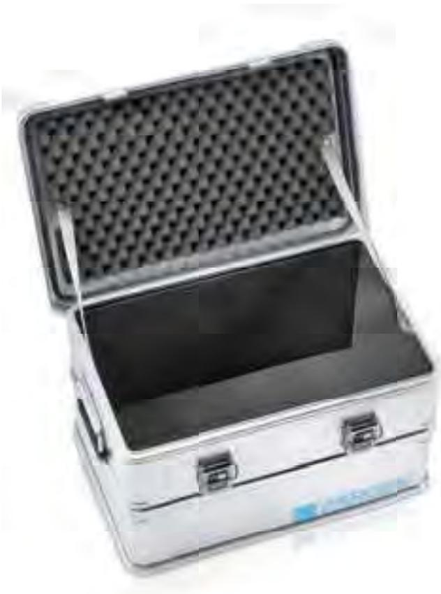
Langlebige und abriebfeste Auskleidung durch physikalisch vernetzten PE-Schaum in Boden und Wänden (Raumgewicht 40 kg/m<sup>3</sup>, Stärke 11 mm) sowie Noppenschaum im Deckel. Einfacher Einbau durch selbstklebend ausgestattete Wände und Deckel. Der Boden wird eingelegt.
