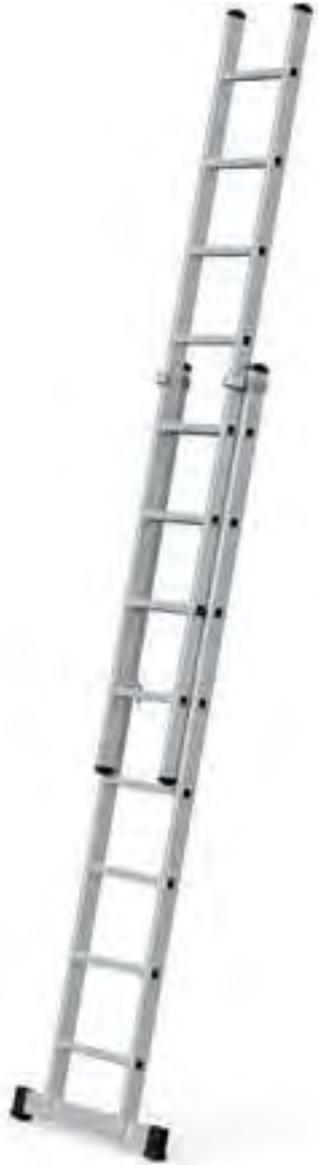
Die komfortable Lösung für Arbeiten in großen Höhen mit maximaler Leiterbreite für bequemen Aufstieg und sicheren Stand. Ab Länge 8,30 m Oberleiter mit Laufrollen. Laufrollen mit abriebfester, wandschonender Lauffläche. Bequem und präzise von Sprosse zu Sprosse im Raster von 280 mm höhenverstellbar. Beide Leiternteile auch separat als Anlegeleitern einsetzbar bei Bestell-Nr. 40245-40247.
