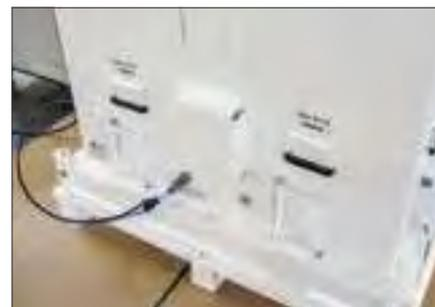
Wasserdampfdichter Behälter bei Dichtheitsprüfung durch Überdruck
