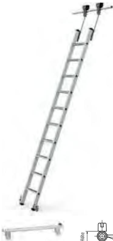
Fürs Hin und Her am Regal: die Lösung mit Laufschiene und Federbremsrollen kann in der Höhe individuell angepasst werden. Sowohl der fahrbare Leiternkopf als auch die Federbremsrollen unten arretieren die Regalleiter bei Belastung. Im Ruhezustand kann die Leiter platzsparend an das Regal gestellt werden.
