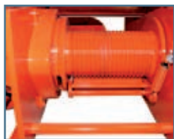
Seilandruckrolle Pressure roller Rouleau presse cable
