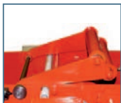
Schlaffseilsschalter Slack-rope switch Détection de brin mou
