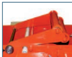
Schlaffseilschalter Slack-rope switch Détection de brin mou
