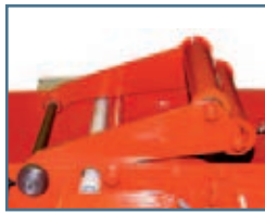
Schlaffseilschalter (3) Slack-rope switch (3) Détection de brin mou (3)
