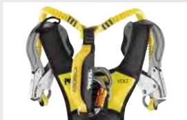
Die Gurte verfügen an jedem Schulterträger über ein Verstausystem für die MGO-Verbindungselemente der Verbindungsmittel zur Absturzsicherung. Im Falle eines Sturzes ermöglicht dieses System das Aufreißen des Falldämpfers durch Freigabe der MGO-Verbindungselemente.
