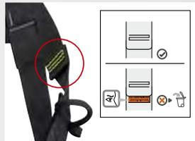
Sternale und dorsale Auffangöse sind mit Sturzindikatoren versehen: Nach einem Sturz ist ein rotes Gewebe sichtbar, was bedeutet, dass der Gurt gesondert werden muss.
