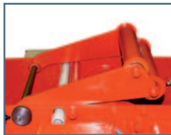
Schlaffseilschalter (3) Slack-rope switch (3) Détection de brin mou (3)
