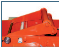
Schlaffseilschalter (3) Slack-rope switch (3) Détection de brin mou (3)
