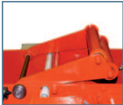
Schlaffseilschalter Slack-rope switch Détection de brin mou
