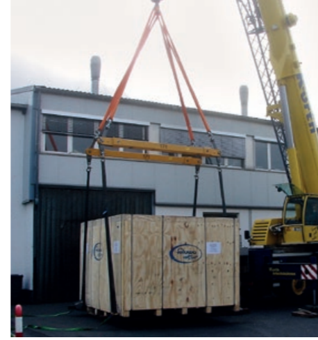
Spreiztraversen-Gehänge Anschlag unterhalb des Lastschwerpunktes
