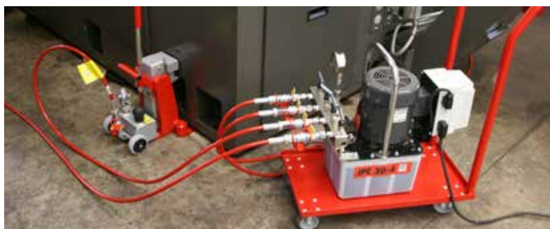
Elektropumpe JPE 30/4 NVR mit 4 Hebeegeräten im Einsatz
