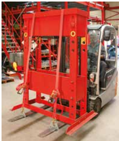
Ladungssicherung mit Gabelklemmen und Spanngurten
