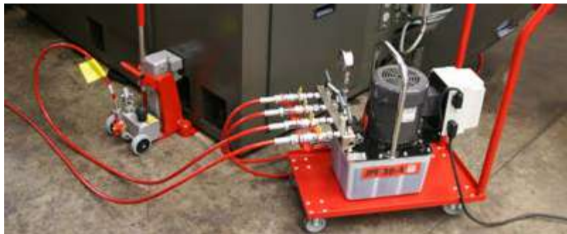
Elektropumpe JPE 30/4 NVR mit 4 Hebeegeräten im Einsatz.
