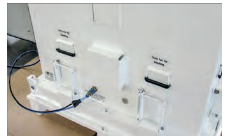
Wasserdampfdichter Behälter bei Dichtheitsprüfung durch Überdruck
