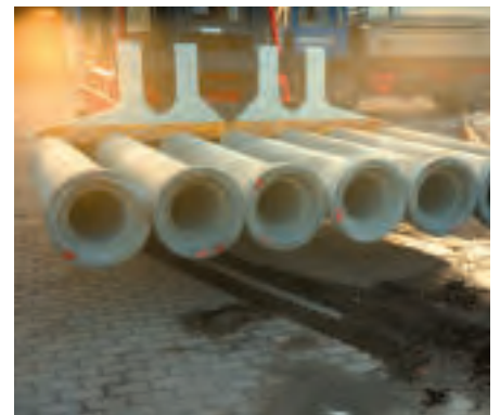
Durch die frei drehbaren secutex-Rohrmodule werden Kratzer im Rohrrinnern vermieden. Aufwändige, nachträgliche Rissuntersuchungen werden dadurch reduziert.
