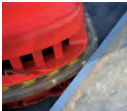
secutex Hohlprofil als Rammschutz des Gabelstaplers gegen Beschädigungen.
