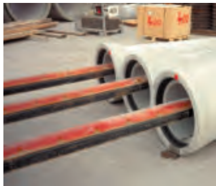
secutex Zinkenschutz-Schuhe halbrund verhindern zuverlässig Beschädigungen an den Dichtflächen.
